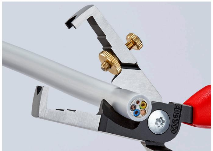
感应淬火的电缆刀片带圆切刃，剪切铜电缆最大直径 $\varnothing 15\text{mm}$  ( $5 \times 2.5\text{mm}^2$ )，无毛刺。
